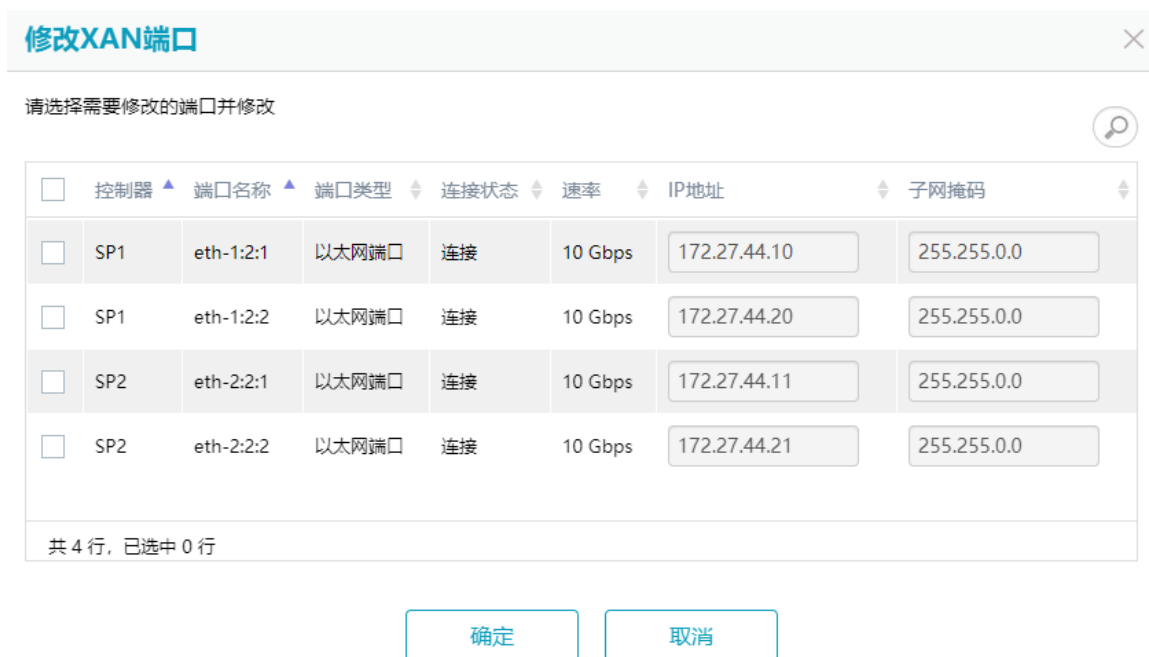
图6-14 修改 XAN 端口界面
